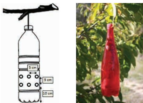
Figure 2 - Piège « artisanal » pour la surveillance de D. suzukii
