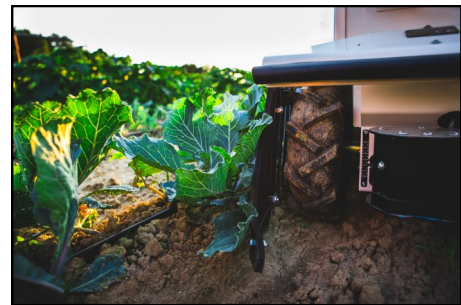
Ainsi que des options : pare-feuilles pour protéger les feuilles des cultures des roues, siège de travail à roue et remorque.
