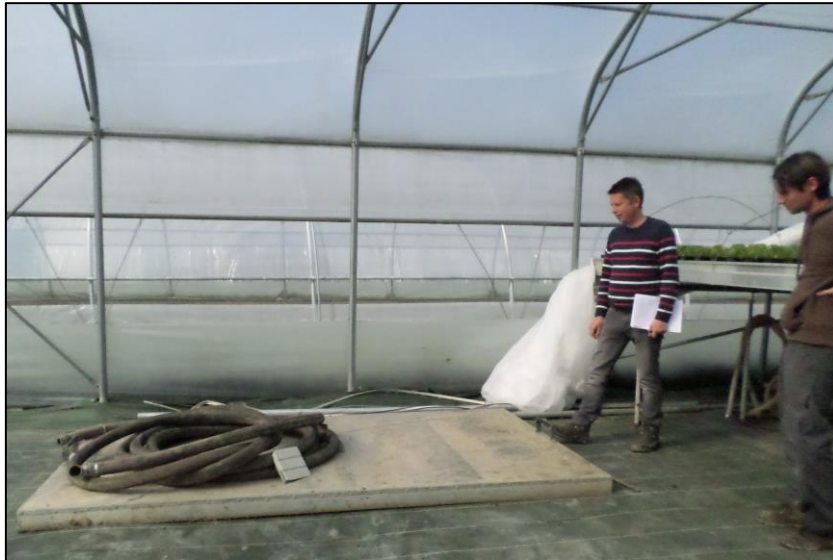
Cloche de 5 m 2 , en aluminium, reliée à la chaudière et qui est déplacée dans la serre pour l'injection de vapeur
