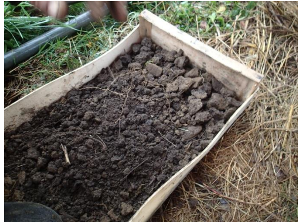
Fig. 10 Test EVS - Structure
