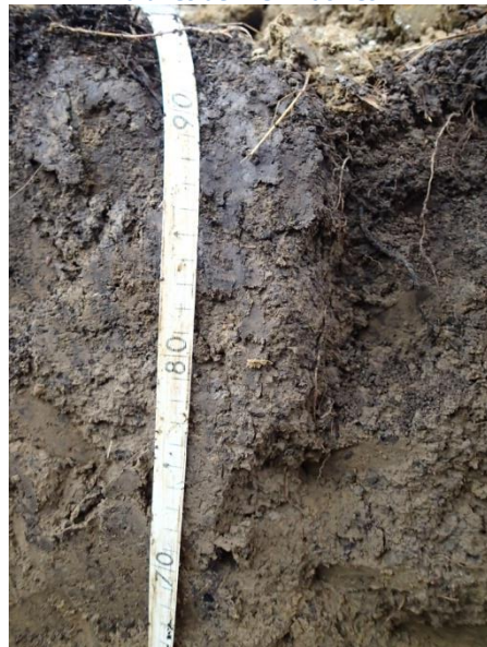
Fig. 13 Limite entre H1 et H2 – assez franche – tâches brunes de MO dans H2
