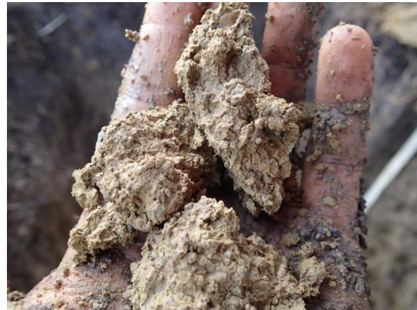
Fig. 14 Test EVS – Structure + Porosité – 55 cm de profondeur
