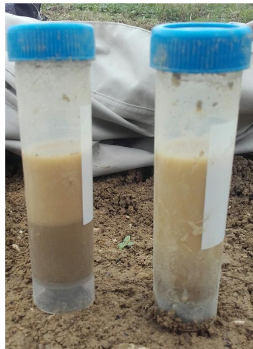
Fig. 7 Test de sédimentation – après quelques minutes A gauche : en surface ; A droite : au fond
