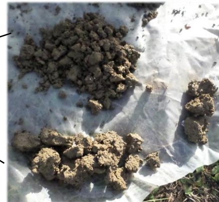
Test bêche : bloc tient sur la bêche mais pas sur la bâche, fissure horizontale à 15 cm de profondeur
