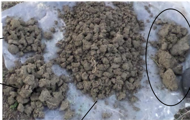
Test bêche : bloc tient sur la bêche mais pas sur la bâche, fissure horizontale à 15 cm de profondeur
