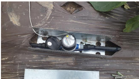
Figure 7 : Compteur d'eau installé au niveau de la gaine de goutte à goutte et sondes implantés à 15 et 35 cm sur 3 secteurs différents/tunnel.
